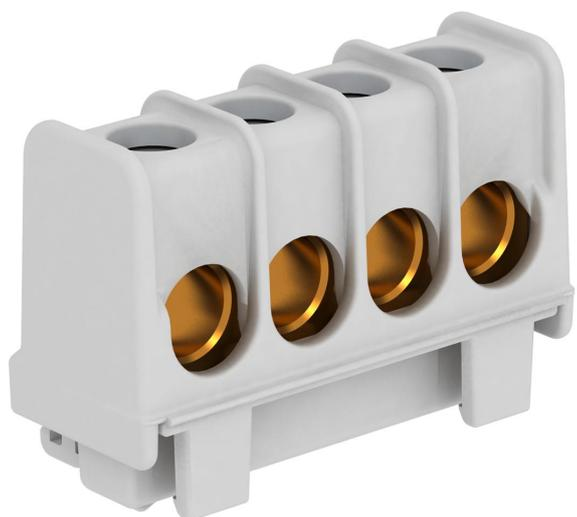
Bornes en laiton, vis en acier, galvanisées (passivation transparente), section nominale 16 ÷ 35 mm<sup>2</sup>, tension nominale 400 V, 1 pôle, avec bornes à douilles sections de raccordement maximales par point de raccordement: 4x35 mm<sup>2</sup>, 4x25mm<sup>2</sup>, 8x16mm<sup>2</sup> ou 12x10mm<sup>2</sup>.
